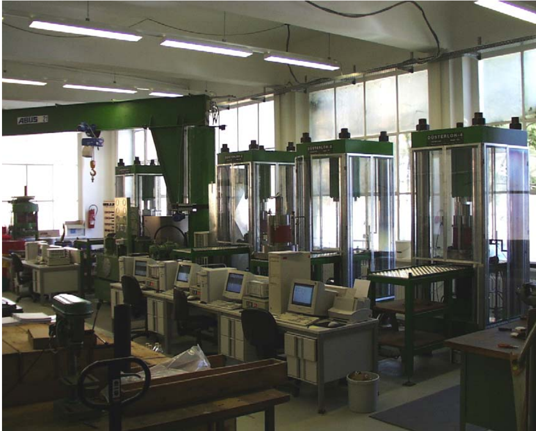
Abb. 4.1: 2500 kN-Druckprüfanlagen des Lehrstuhls für Deponietechnik und Geomechanik
