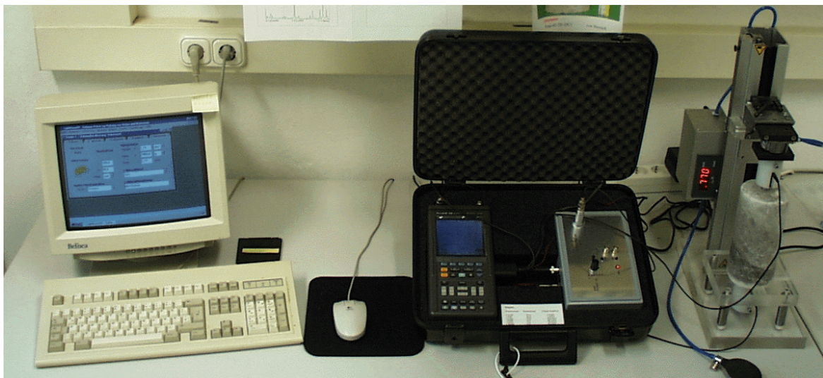
Abb. 3.1: Dehnwellenmessplatz des Lehrstuhls für Deponietechnik und Geomechanik
