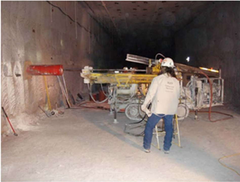
Abb. 4.2-1: Herausbohren von "clean salt" – Großkernen in der WIPP-site.
