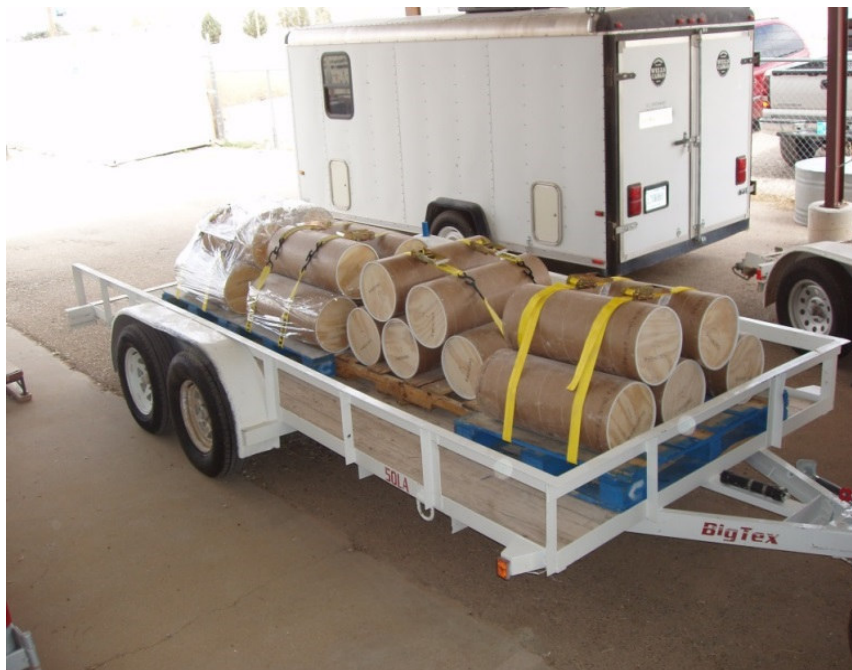
Abb. 4.2-2: Verpackung von "clean salt" - Großkernen auf der WIPP-site.
