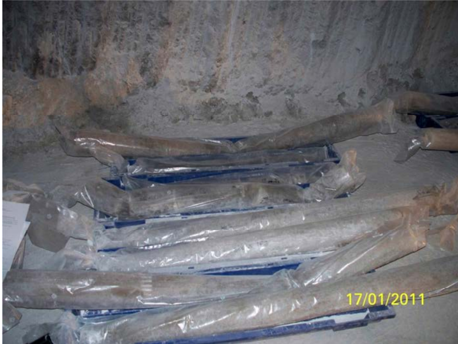
Abb. 3.2-2: Kerne aus Staßfurt-Steinsalz Na 2 SP im ehemaligen BGR-Versuchsfeld der 800-m-Sohle.
