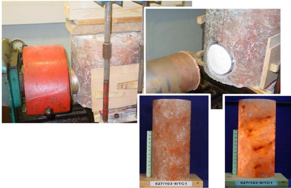
Abb. 4.2-3: Herstellung der Prüfkörper auf einer Drehbank.
