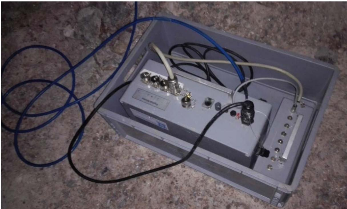
Abbildung 74: Messsignalwandler (links) und Verteiler (rechts) während des In-situ-Versuchs [Sch16]
