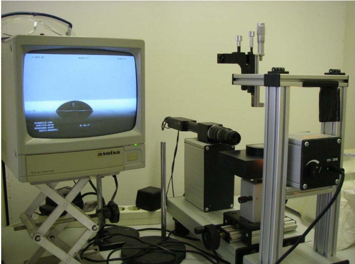
Abbildung 21: Kontaktwinkelmessgerät (TU Bergakademie Freiberg, Institut für mechanische Verfahrenstechnik und Aufbereitungstechnik)
