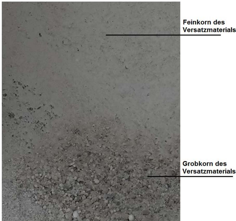
Abbildung 81: Nahaufnahme eines eingeblasenen Versatzlörpers mit GESAV-Material
