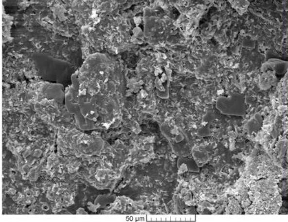
Abbildung 38: REM-Aufnahme eines Halitkorngefüges mit neu gebildeten Salzmineralisationen
