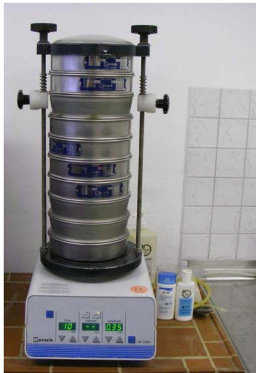
Abbildung 6: Siebmaschine am Institut für Bergbau und Spezialtiefbau des Typs Retsch VE 1000
