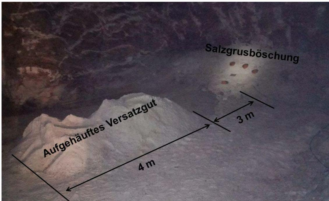
Abbildung 75: Untertägiger Versuchsort vor Versuchsbeginn [Sch16]
