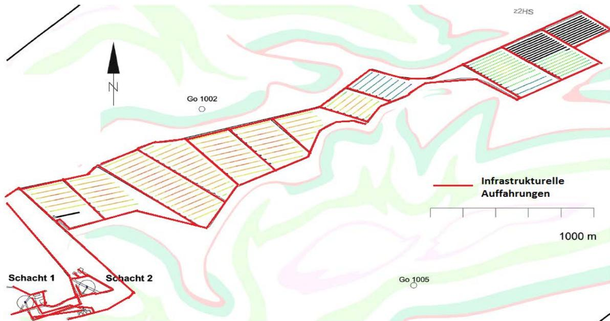
Abbildung 4: Ausmaß der zu versetzenden infrastrukturellen Auffahrungen in einem theoretischen Endlager [Bol14]
