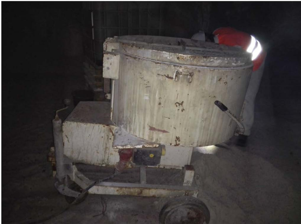
Abbildung 72: Verwendeter Zwangsmischer für untertägige In-situ-Versuche in der Grube Sondershausen [Sch16]
