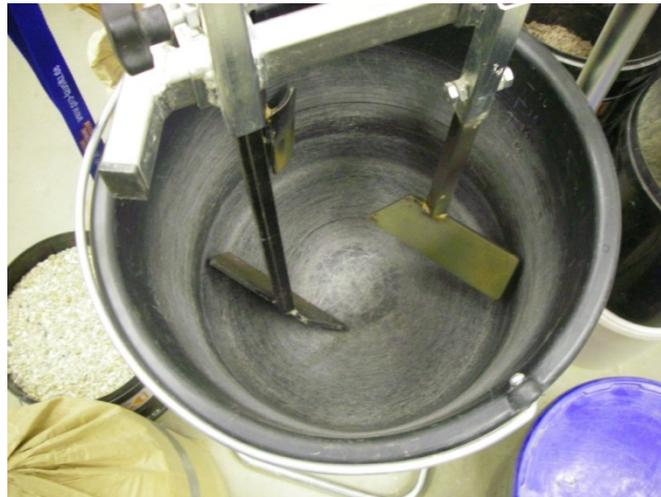
Abbildung 43: Zwangsmischer am Institut für Bergbau und Spezialtiefbau der TU Bergakademie Freiberg
