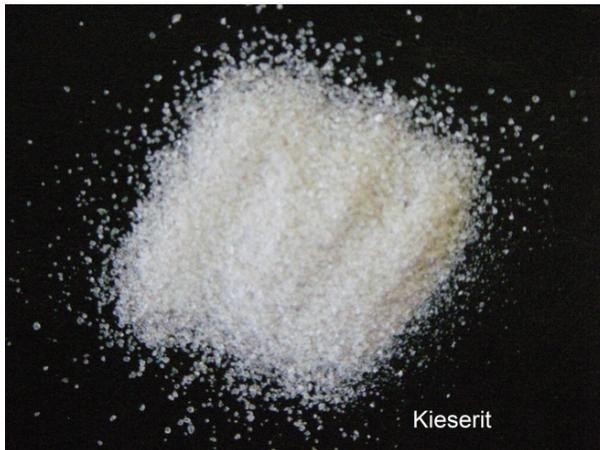
Abbildung 28: Magnesiumsulfat-Monohydrat des Salzbinders
