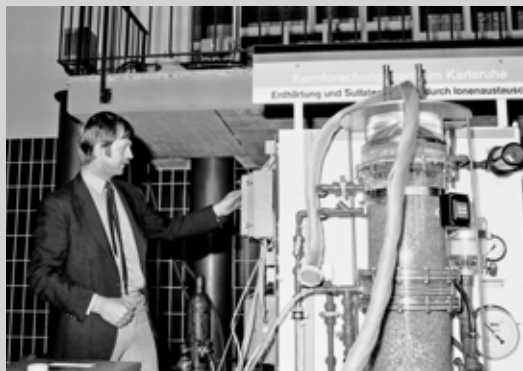
Dr. Hartmut Höll vom Institut für Radiochemie und PtWT mit der von ihm entwickelten Trinkwasser-Aufbereitungsanlage CARIX, die Ionenaustauscher mit Kohlendioxid regeneriert, Mai 1982
