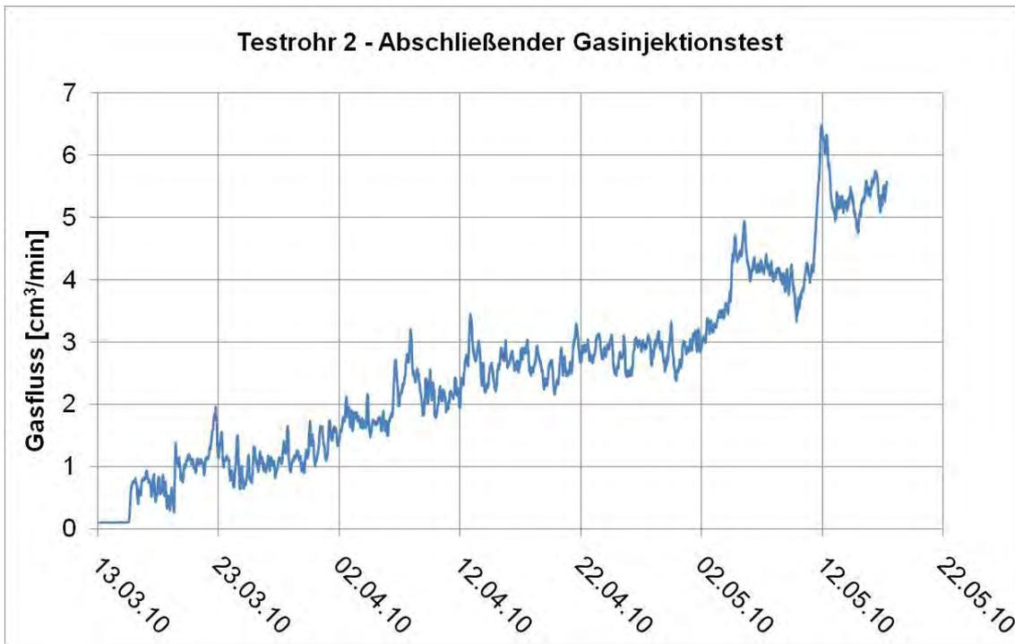
**Abb. 2-6 Entwicklung der Gasfließrate nach Eintreten eines kontinuierlichen Gasflusses nach Gasdurchbruch**
