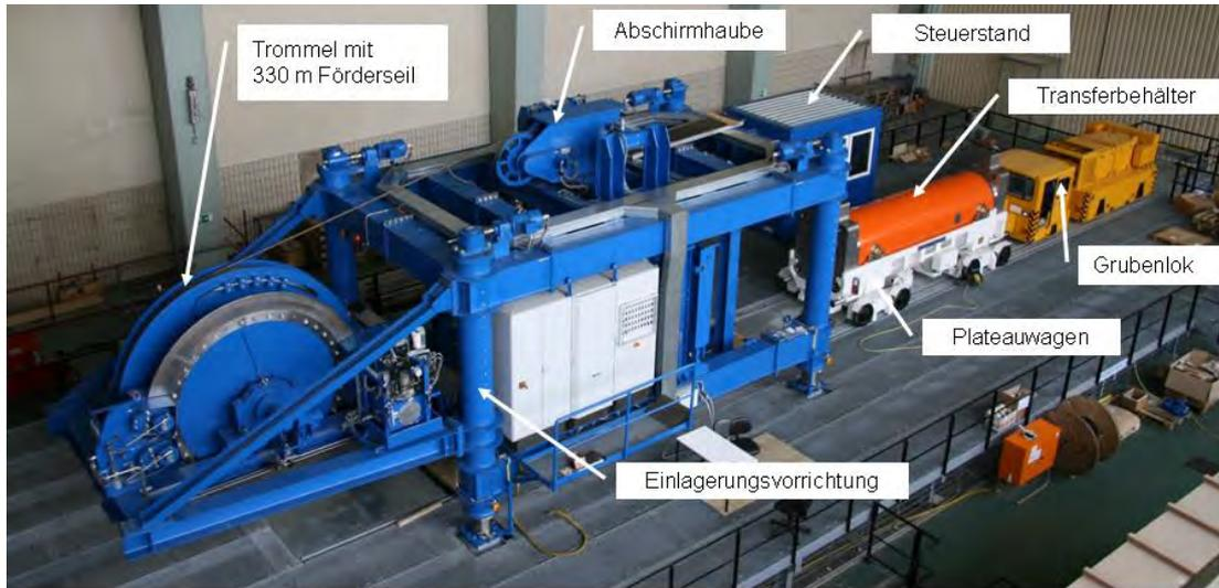
Erprobung der Transport- und Einlagerungstechnik für Brennstabkokillen im Maßstab 1:1 (2008/2009)
