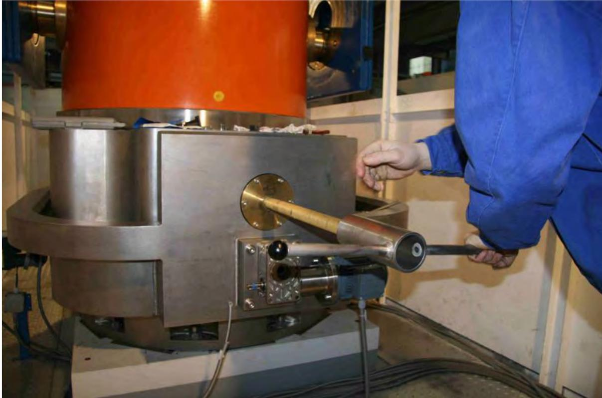
**Abbildung 10: Notbetätigung Bohrlochschleuse**
