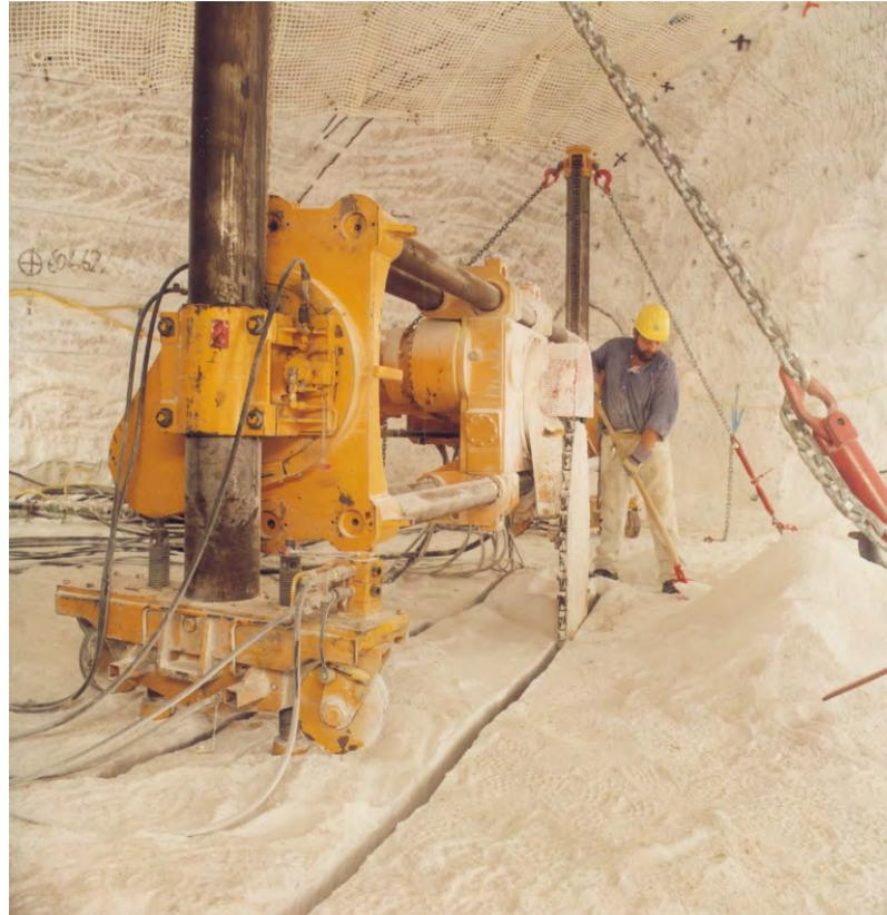
Kettenschrämmaschine - Korfmann Schrämmaschine HSTK 60 NS
