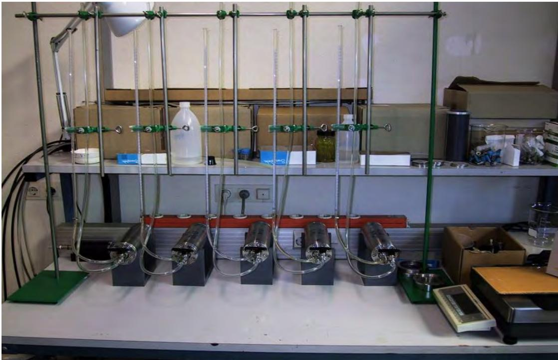
**Abb. 2-2 Versuchsaufbau zur Ermittlung der hydraulischen Parameter des SB-Materials**
