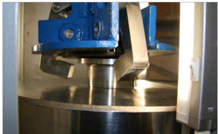
**Abbildung 11: Absetzen der BSK 3 auf Salzuntergrund und Öffnen des Greifers bei max. Schrägstellung**
