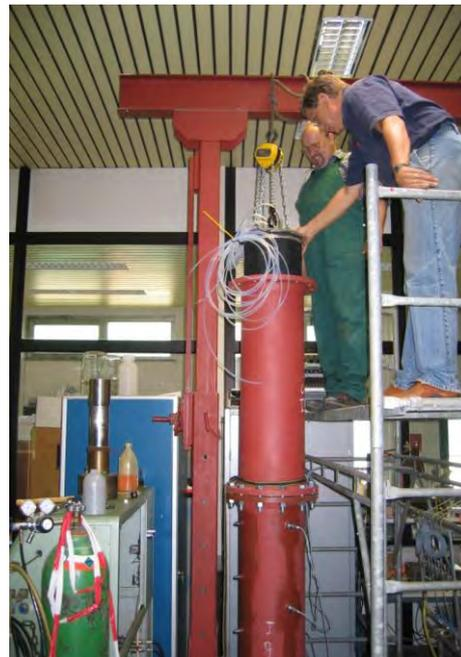
**Abb. 2-3 Prinzipieller Aufbau der großmaßstäblichen Laborversuche (Mockup-Tests) (links), Einbau des Packers (rechts)**
