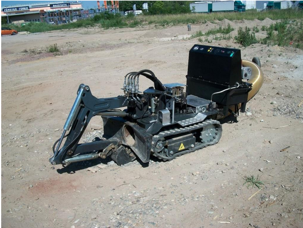
Abb. 2: „Mooneer“ mit Tieföffel und Saugleitung
