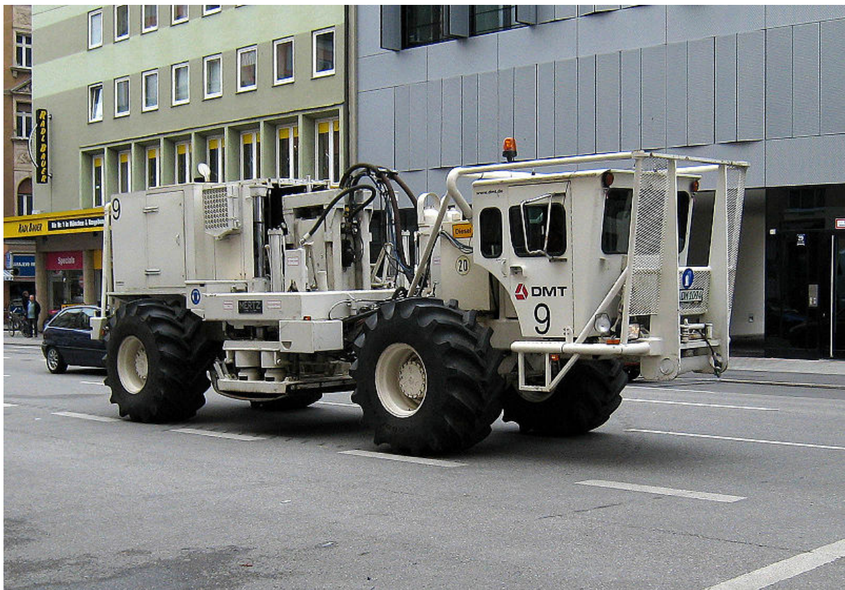
Geländeträgerfahrzeug MERTZ M12P/602 mit MERTZ M12 Vibrator (Foto: Horemu, 08.09.2007, http://de.wikipedia.org/wiki/Datei:Vibroseis_Vehicle.jpg )
