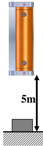
5 m Fall des TFB in der Konditionierungsanlage auf einen Stoßdämpfer (1)
