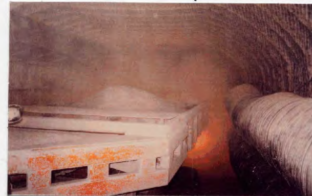
VERSATZ-SCHLEUDERTRUCK IN EINER EINLAGERUNGSSTRECKE
