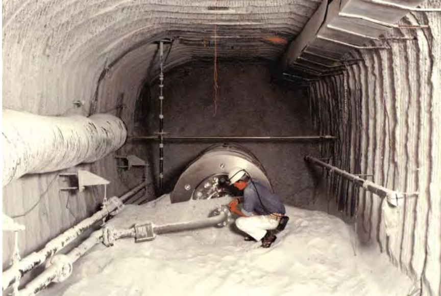
Montage der Versuchsbehälter und Messinstrumente
