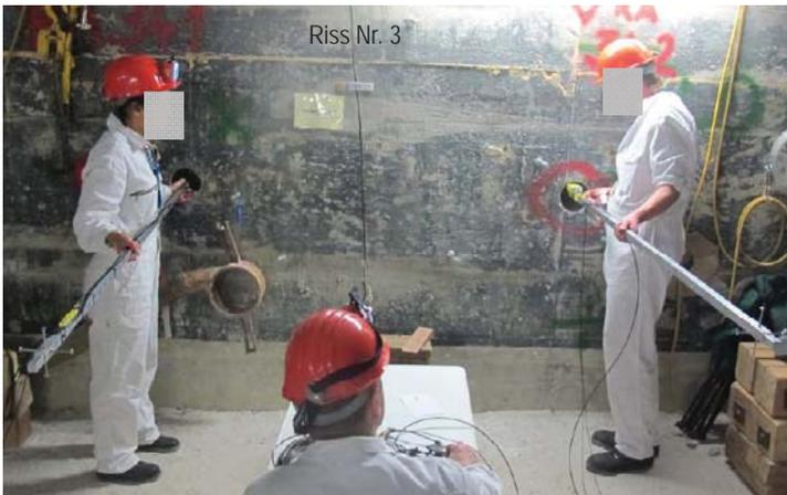
Einsatz der BAM-Bohrlochsonden für Reflexions- und Transmissionsmessungen zwischen 2 Bohrungen (für Bohrl Lochdurchmesser: 133 mm, bisherige Messlänge: 30 m)
