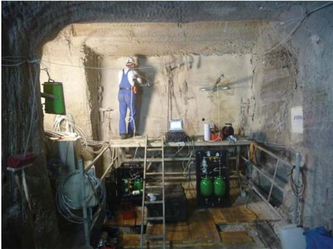
In situ Permeabilitätsmessungen (IBeWa, IfG) direkt im MgO-Spritzbeton
