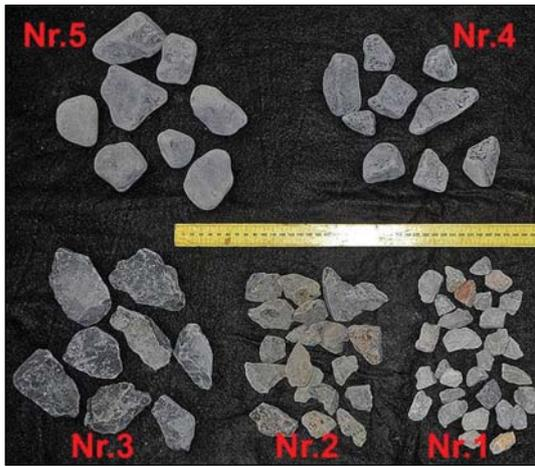
Auswahl eines geeigneten Stützkorns
