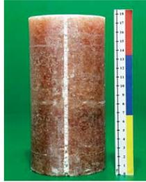
mineralisierte Fuge 5mm
