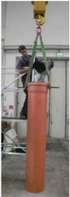
Bestimmung des Reibungskoeffizienten durch die Nachrechnung eines Schüttversuchs im Labor
