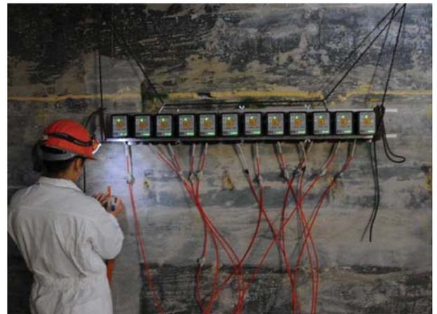
LAUS-Messsystem der BAM (Large Aperture Ultrasonic System) (Eindringtiefe > 5 m bis ca. 10 m)
