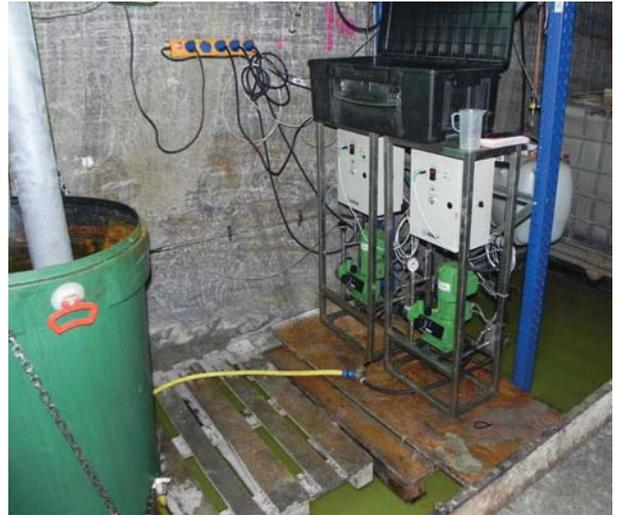
Pumpanlage zur Druckbeaufschlagung des GV2
