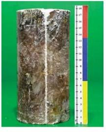
mineralisierte Fuge 2mm
