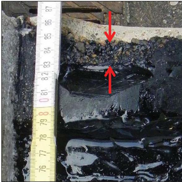
Penetration des Sperrbitumens in den Porenraum der Kontrollkammer
