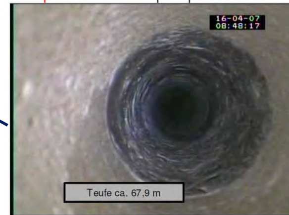
Untersuchungsbohrung PSB A1 EB 1, Übergang vom Sorelbeton zum Steinsalz bei Bohrlochteufe 67,9 m
