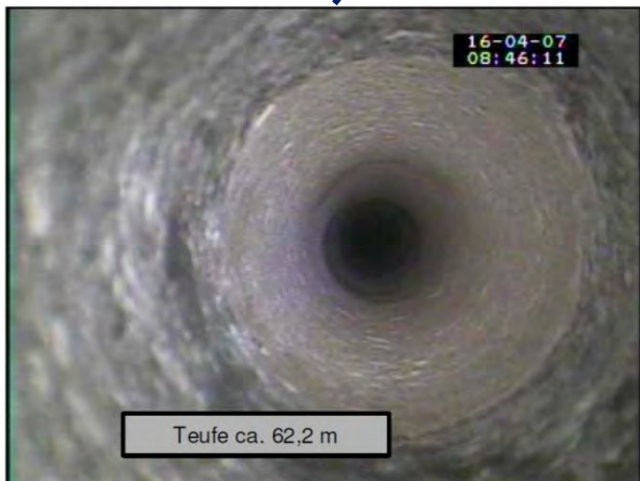
Untersuchungsbohrung PSB A1 EB 1, Übergang vom Steinsalz zum Sorelbeton bei Bohrlochteufe 62,2 m
