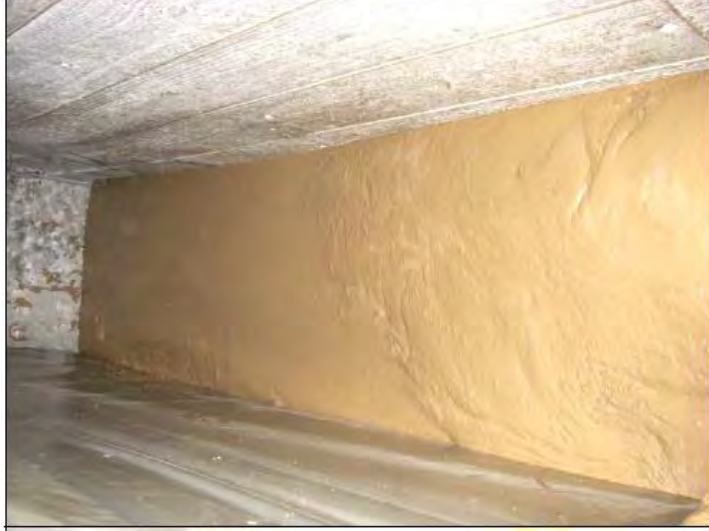
5. Betonierabschnitt (4 kg Zuschlag / kg MgO)
