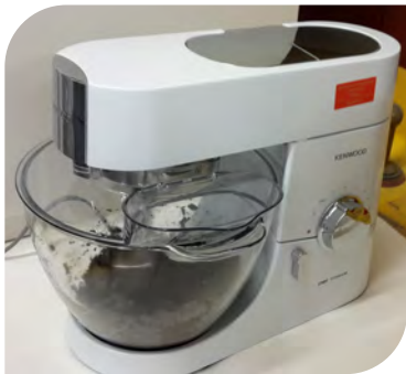
Anrühren des Zementleims
