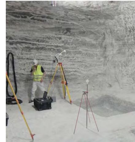
**3D-Laserscan + Nivellement**
