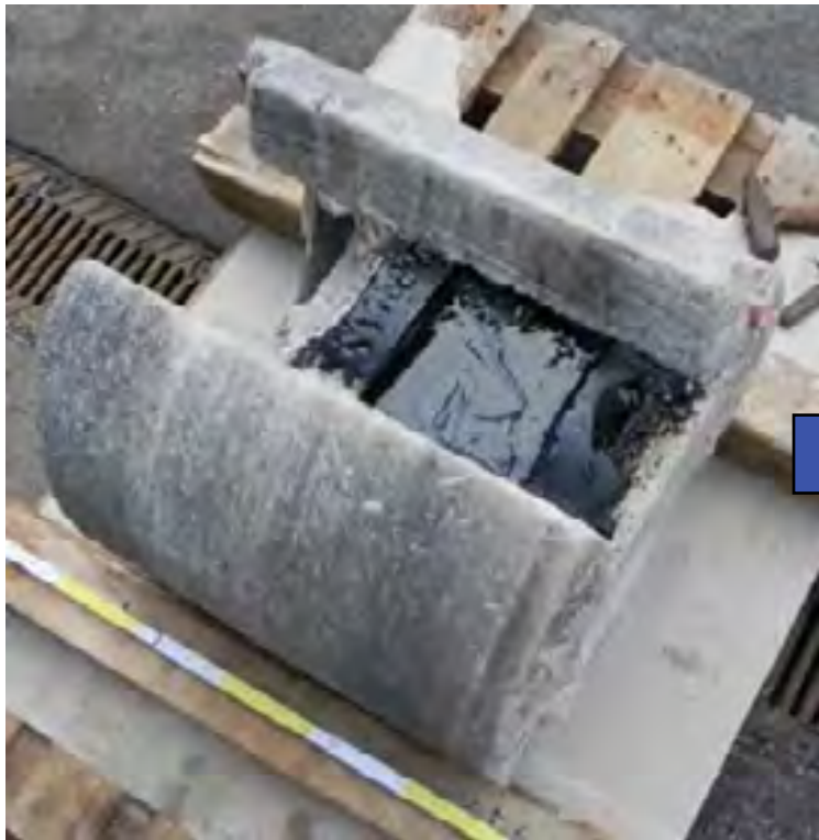
Überbohrter Kern (D = 0,5 m) nach Gasdruckbeaufschlagung
