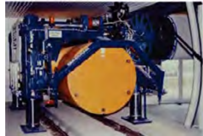
Prototyp der Einlagerungsvorrichtung im Versuchsstand
